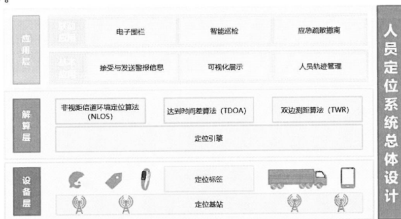
图 1 人员定位系统总体设计
